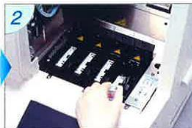
2 試薬パック、チップ、反応チューブを装置にセットする
